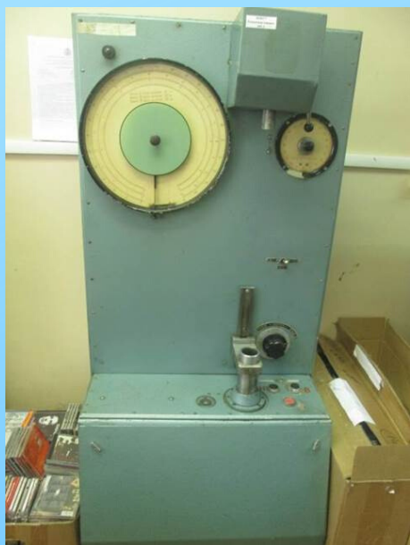
PT-250-M машина для определения прочности материала
