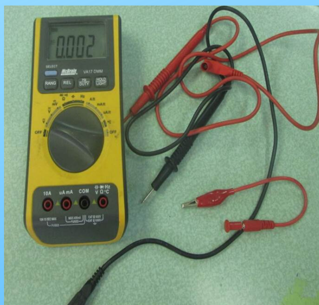
Мультиметр VA17 универсальный электроизмерительный прибор
