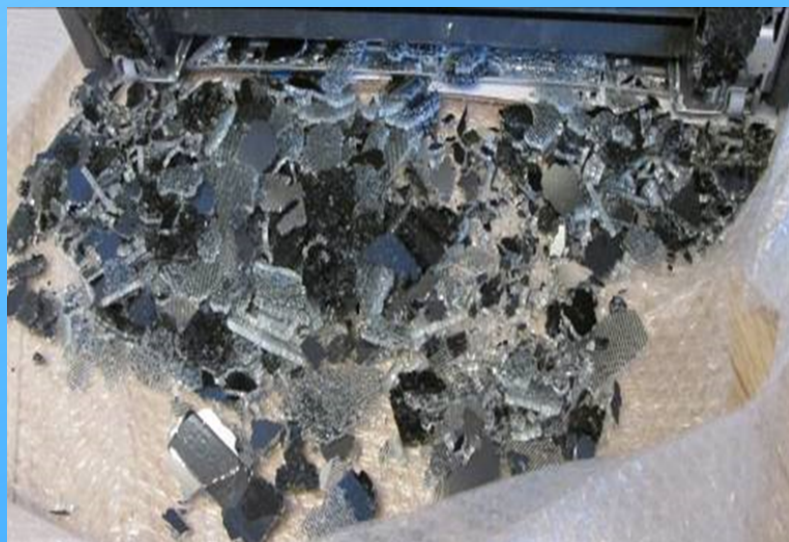
Разрушение закаленного стекла при нагреве духового шкафа
