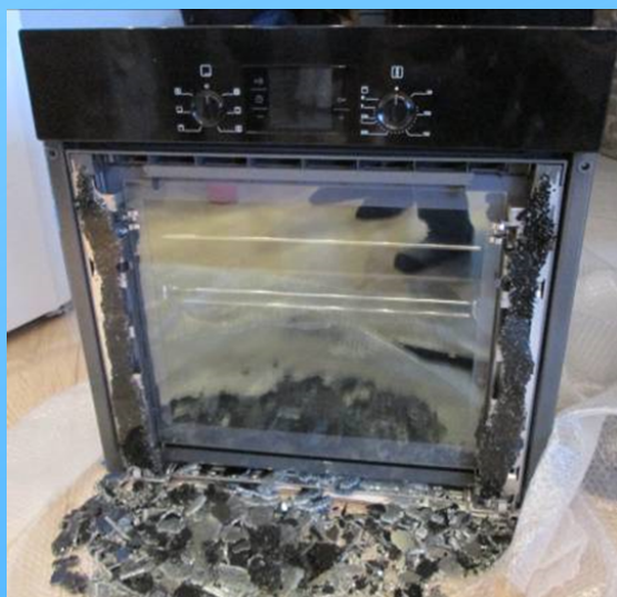
Разрушение закаленного стекла при нагреве духового шкафа
