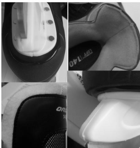
Рис. 2. Дефекты образца «Oroks»
