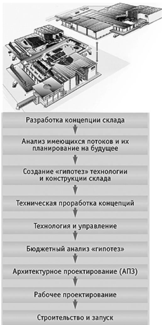
Рис. 1. Методология проектирования технологического процесса на складе
