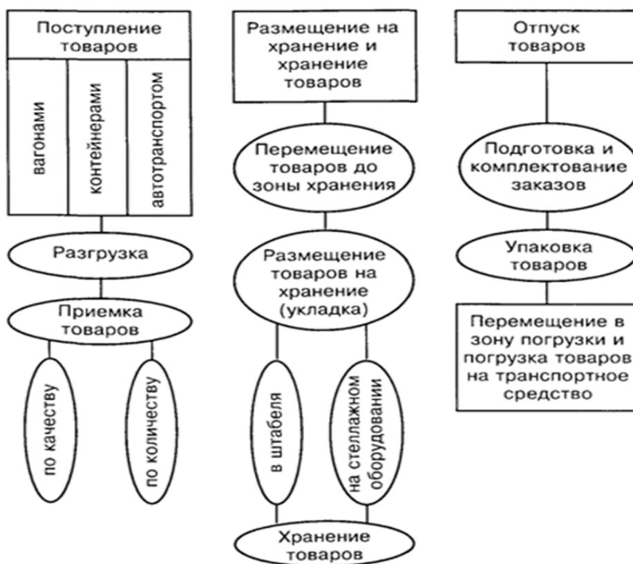
Рис. 1. Схема технологического процесса на складе
