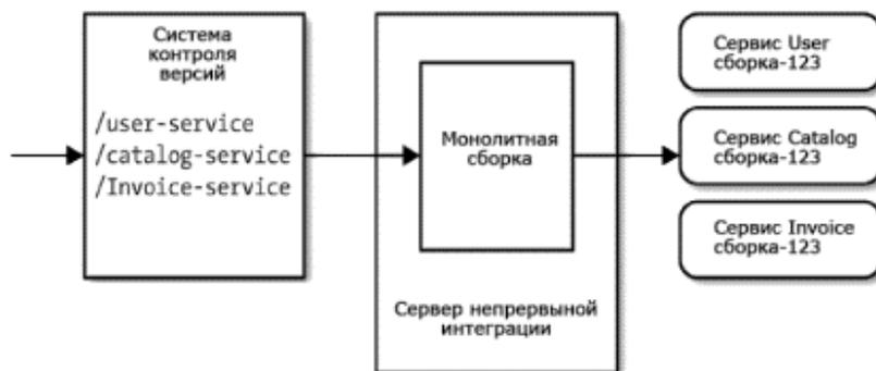
Рис. 2. Монолитная сборка
