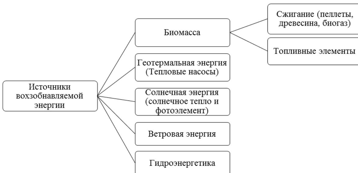
Рис. 1. Распространенные источники воспроизводимой энергии, применяемые в зданиях
